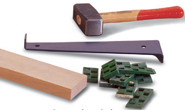
Oprządkowanie do montażu paneli: ciężki młotek dwustronny, klocek z twardego drewna, klamra dociskowa i kliny dystansowe.
